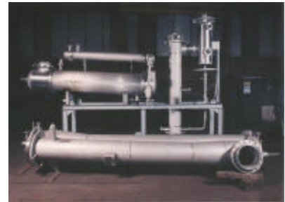
Strahler für Vakuumanlage
